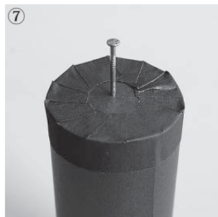
⑦ 光漏れがないか、筒をのぞいて確認します。光漏れがなければ、「3」の中央に穴をあけます。写真では太さ1.6mm釘を使っています。
