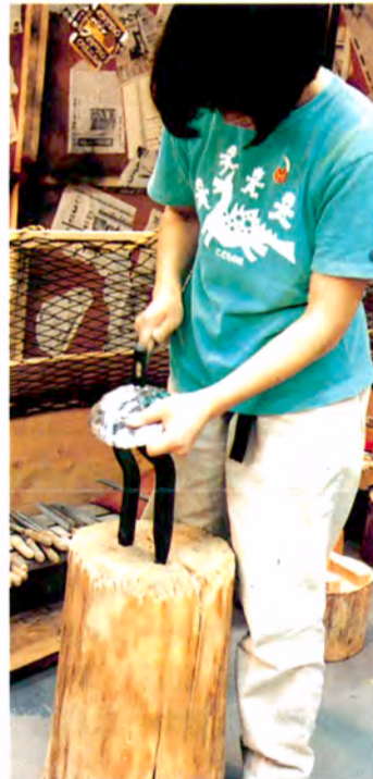
◀専用の道具を使って金属をたたいて形を整えているところ。
